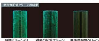
配管クリーンなし 従来の配管クリーン 熱洗淨配管クリーン
